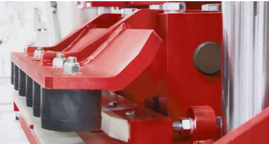
Боковая направляющая формы в зажиме формы (стандарт)
