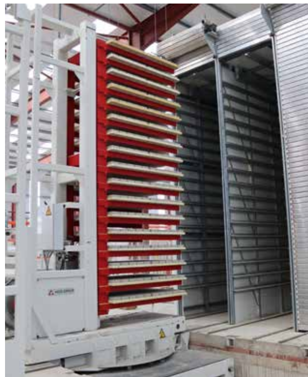
Транспортно-складирующая группа с различными вариантами грузоподъемности (8,5т, 14т, 24т)
